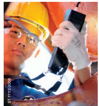
Dräger X-am 5000 Optionale externe Pumpe für Freigabemessungen
