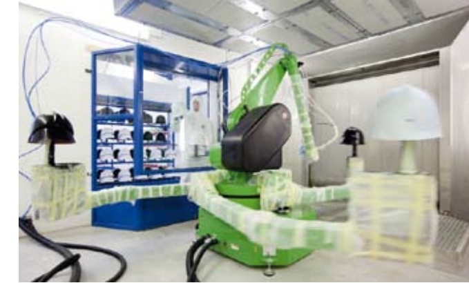
Lackieren im Minutentakt: Über einen fünfarmigen Lackierroboter erhält der Helm die gewünschte Farbe – eine von sieben möglichen.
