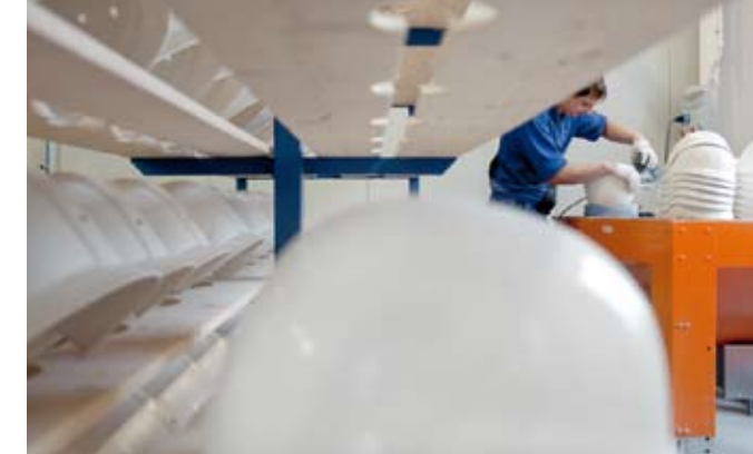
Nahtlos glänzend: Manuelles Schleifen und Polieren ist aufwendig, aber für die perfekte Kombination von Form und Funktion gibt es nichts Besseres.
